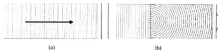
FIGURA 11-4. Visão de cima para baixo de dois tanques percorridos por ondas, com detectores na extremidade oposta (da direita) de cada um, que medem a máxima altura da onda em cada ponto ao longo da parede oposta ao foco de propagação da onda. À direita de cada tanque, existe uma linha negra que indica a altura relativa da onda ao longo do detector. Ondas uniformes são geradas na parede esquerda de cada tanque. (a) Sem barreiras. Ondas paralelas atingem o detector, apresentando a mesma altura em cada ponto. (b) Barreira com ranhura única. Ondas circulares se formam no local da parede que agora se transformou em uma fonte “pontual” (a ranhura) e que, desse modo, se tornam progressivamente mais fracas à medida que se distanciam da fonte.
